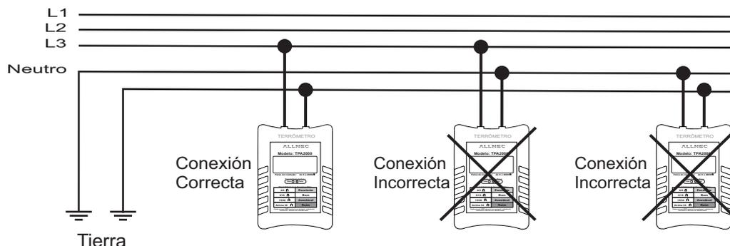
**Observaciones:** Ningún medidor de tierra mide el tierra con el neutro conectado; siempre medirán la resistencia más baja, independientemente del modelo o fabricante del dispositivo. En ese caso, el tierra deberá desconectarse del neutro.
